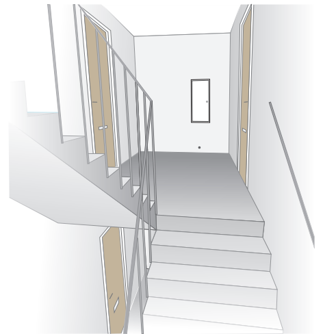
Placera schakt så att de är lätt åtkomliga för service, reparation eller utbyte.
